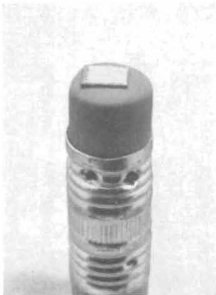
Un microcircuito integrato sperimentale, comprendente 456 componenti attivi che svolgono le funzioni di un completo circuito di 64 unità di memoria Flip-Flop e di tutti gli elementi di decodificazione d'ingresso, appoggiato sul gommino di una matita.
