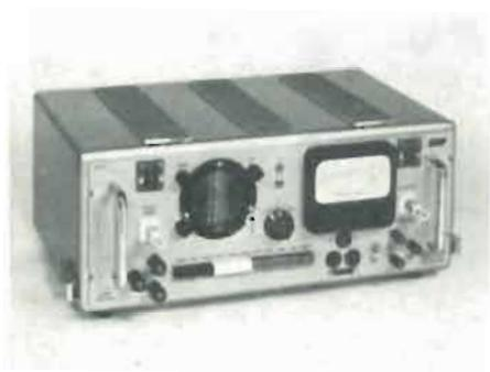
Misuratore delle fluttuazioni della velocità di scorrimento di magnetofoni, giradischi e cinema sonoro costruito dal LABORATOIRE ELECTRO-ACOUSTIQUE (LEA) di Rueil S-F-O, Francia.
